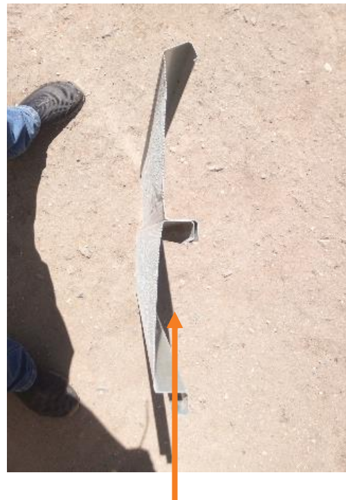
НЕТ бокового изгиба вниз на 50 мм, с меньшим продольным сопротивлением, приводит к изгибу аэрационного покрытия.
